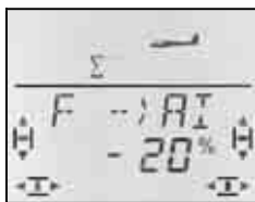
Curseur vers l'arrière: Les deux ailerons vers le bas
